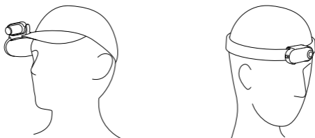
B. 簡易夾 (角度可調節, 建議角度調整為水平略朝下)
