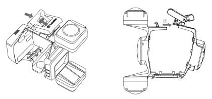
**步骤二:**如下图所示,将相机支架连接扣对应锁合至无人机底部。
