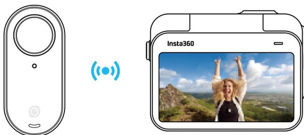
注：当 GO 3 不在位录制，使用拓展舱进行远程预览时，数据通过蓝牙传输，故视频画质降低；实际录制视频的清晰度，均以录制参数为准，不受拍摄方式影响。
