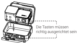
Einsetzen der ONE R
